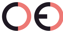
Marca CE falsa (demasiado separados)
